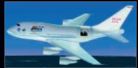
Fliegendes Teleskop SOFIA: Das optische Instrument ist im Rumpf der Boeing 747 installiert.
