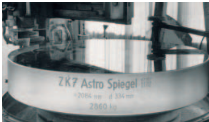
Drei Tonnen wog der erste Nachkriegs-Spiegelträger, den SCHOTT im Jahre 1949 aus dem optischen Glas ZK 7 herstellte.
