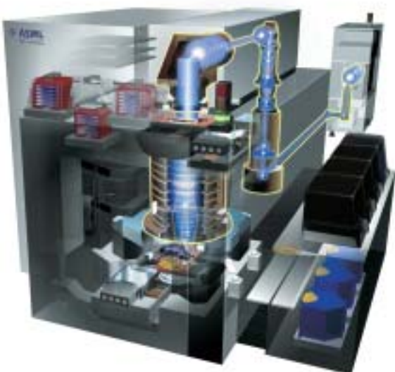
Prinzipskizze ASML-Waferstepper (links). Das US-Unternehmen Cymer hat jetzt mit seinen innovativen XLA 100-Systemen und der sogenannten „MOPA-Technologie“ noch leistungsfähigere Excimer-Lasern entwickelt.
