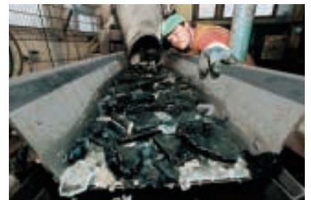
Das Bildröhrenmischglas wird durch Trennung, Reinigung sowie Sortierung aufbereitet.
