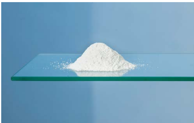
Lithium carbonate is an important raw material for many glass and glass-ceramic products. Lithiumcarbonat ist ein Schlüsselrohstoff für viele Glas- und Glaskeramikprodukte.
