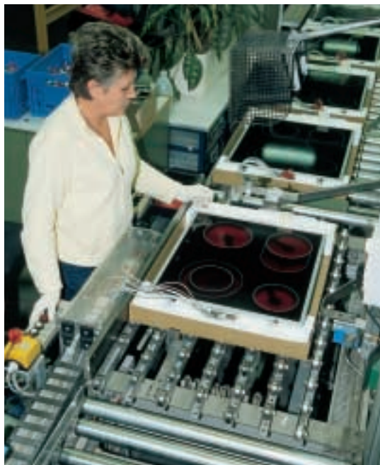
Jede Glaskeramik-Kochfläche wird vor dem Einbau in die Mulde sorgfältig geprüft.
