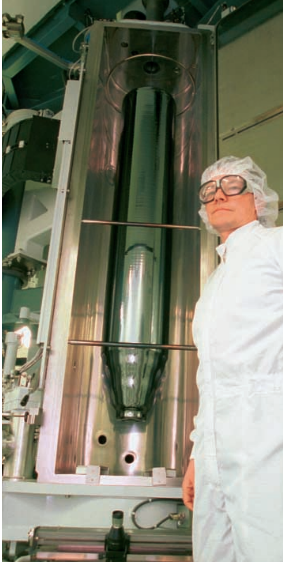
Stand der Technik: Kristallzüchtungsanlage zur Herstellung von Siliziummonokristallen mit einem Durchmesser von 300 Millimeter bei Wacker Siltronic AG.
