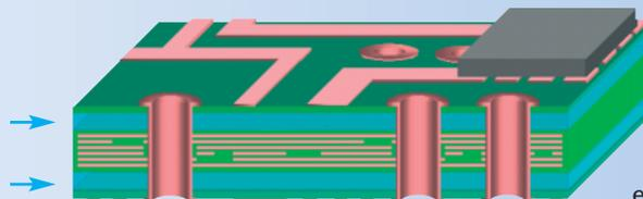
Schichtaufbau eines Multilayer-Laminats. Auf beiden Seiten des Dünnglases (blaue Schichten) wird eine Kupferfolie aufgebracht. Die Schichten sind durch Zwischenlagen aus glasfaserverstärkten Klebern verbunden.
