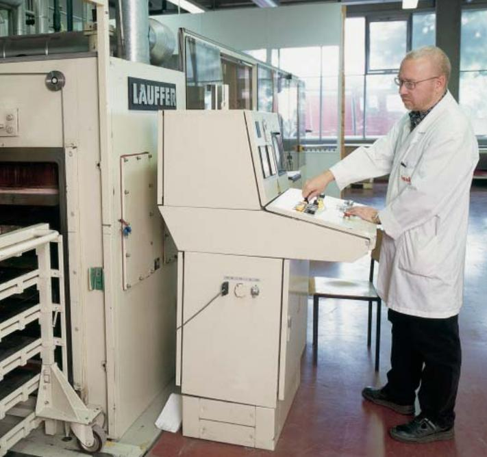
Die Laminat-Rohlinge werden in der Presse bei Temperaturen von 180 °C bis 200 °C weiterverarbeitet.
