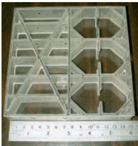
Teststruktur mit „Zerodur“ Glaskeramik für mechanische EUVL-Komponenten.
