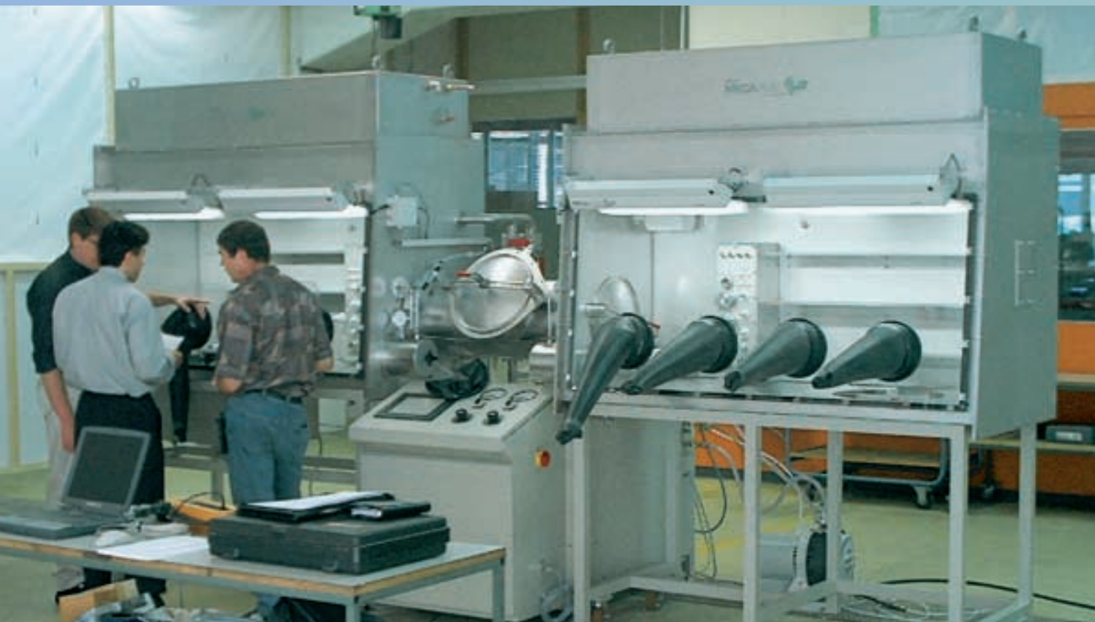
Anlage zur Erforschung und Nutzung der neuen Technologie. Die Prozesse werden unter Reinraumbedingungen und in Inertgasatmosphäre durchgeführt.
