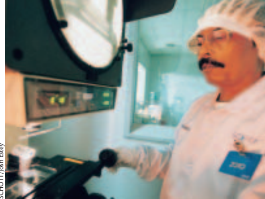
Mit einem Profilprojektor wird berührungslos optisch die Geometrie des Glaskörpers vermessen.
