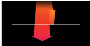
2. ROBAX® Energy Plus reflektiert mehr Wärmestrahlung zurück in den Brennraum als eine unbeschichtete ROBAX® Scheibe.
