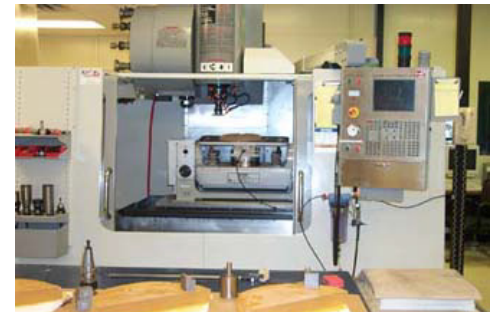
杜里埃 (Duryea) 新安装的 HAAS VF3-SS 立式铣床
