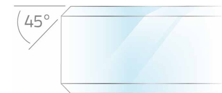
Polierte Kante, Trapezschliff
