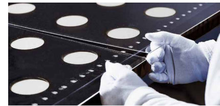
Brechen des Glases an der definierten Kante
