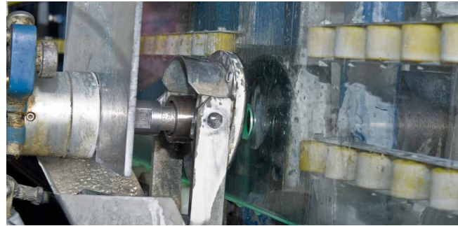
Beidseitiges Bohren mit einer Horizontalbohrmaschine
