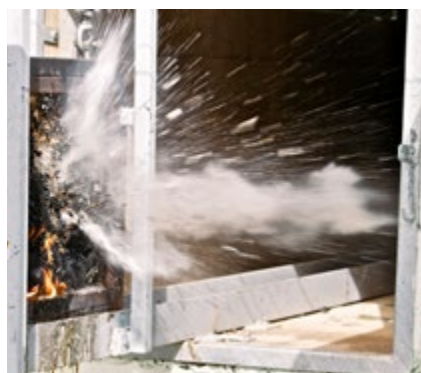
Test: Beschussversuch nach Kleinbrandversuch
