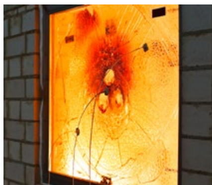
Test: Großbrandversuch nach Beschuss
