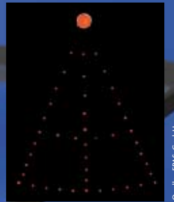
Messprotokoll Parabolspiegel-segment (ø des Brennflecks: 40 mm)
