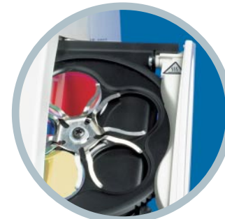
Filterrad für fünf Filterpositionen: Änderungen des Lichtwellenleiterbereichs einfach nur durch Drehung des Rades
