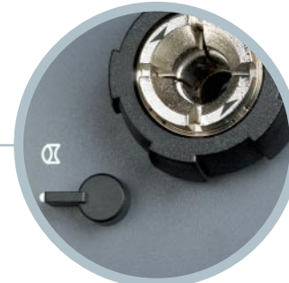
Lichtleiteraufnahme mit Adapter für aktive Durchmesser bis zu 8 mm
