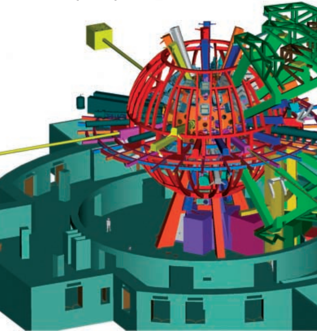
Herzstück des Megalasers: die Targetkammer, wo alle Strahlen auf die Brennstoffkapsel, das sogenannte „Pellet“, treffen
