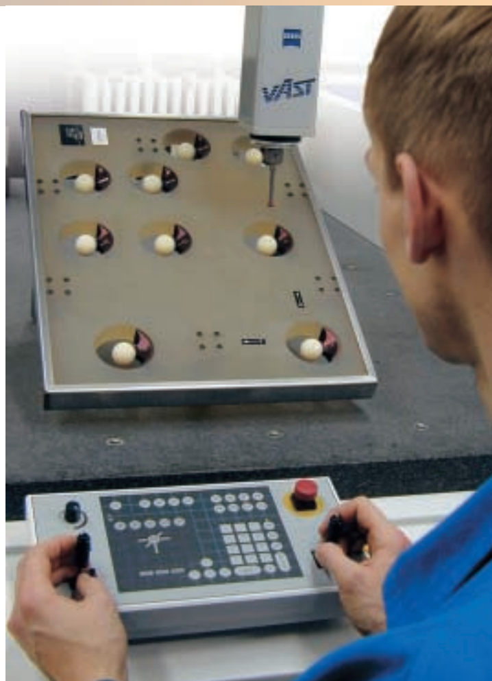
Wird von Messtechnikern und Kalibrierlaboratorien am meisten angewendet: 2D Kugelplatten mit Bohrungen und extrem präzisen Keramikugeln.
