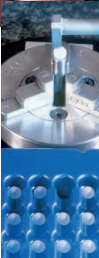
Qualitätskontrolle der Kugellinsen.
