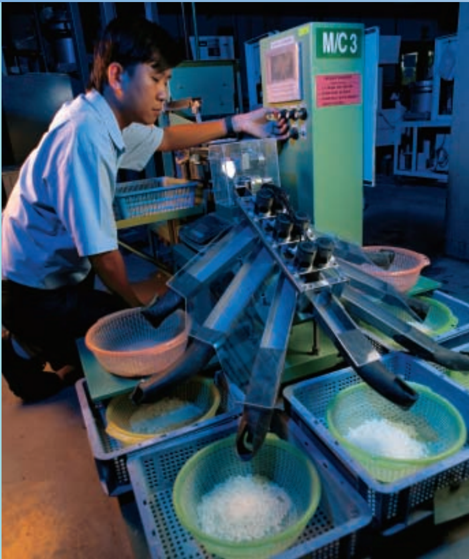
Würfelförmige Vorprodukte für Kleinlinsen werden vollautomatisch nach Gewicht sortiert.
