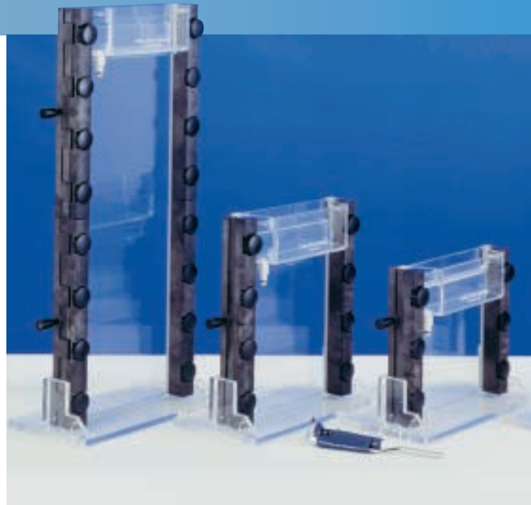
Die Twin-set-Platten aus „Borofloat“ sind aufgrund ihrer chemischen und physikalischen Eigenschaften sehr gut geeignet zur Aufnahme einer 200 Mikrometer dünnen Zwischenschicht bei der Gel-Elektrophorese.
