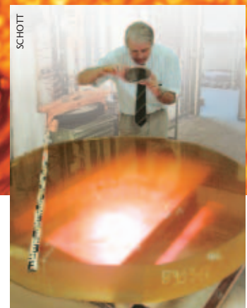
Für das primäre optische System des Sonnenteleskops fertigte SCHOTT zwei ebene Umlenkspiegel aus „Zerodur“ Glaskeramik mit einem Durchmesser von 1,4 Meter.
