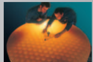
Bei dem „Magellan“-Teleskop kommen auf der Rückseite gewichtserleichterte, ausgefräste „Zerodur“ Leichtgewichts-Spiegelträger zum Einsatz.
