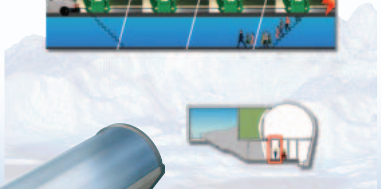
An 37 Stellen kann die Hauptröhre durch feuerfeste Türen verlassen werden. Über eine Treppe erreicht man die darunter liegende Notfallröhre, die ständig mit Frischluft versorgt wird.
