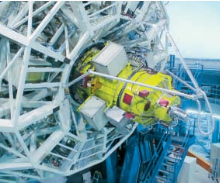
Das VLT-Instrument FORS1 ist an ein Trägerelement eines Hauptspiegels angeflanscht. Die Abbildungsoptik aus Spezialgläsern von Schott befindet sich in dem gelben Zylinder. Die silberfarbenen und roten Kästen enthalten die Elektronik und die Servomotoren für die Steuerung.
