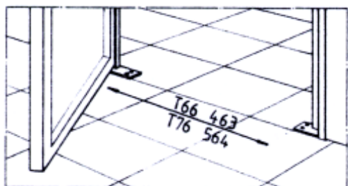
Utförande med kapad tröskel. Kapning görs på plats efter monteringen.
