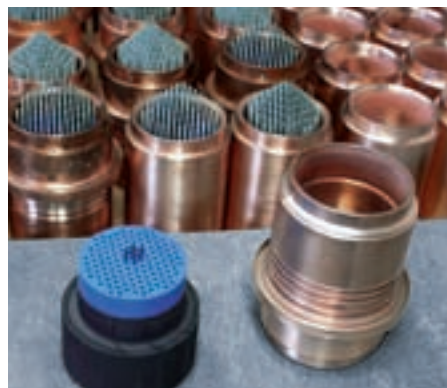
核电厂控制和仪表的电气贯穿件在封装前进行部件装配
