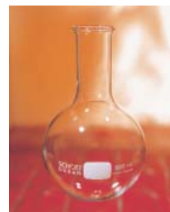
Ballons à fond rond à col étroit et à bord évasé, ISO 1773
