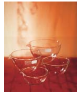
Capsules à fond plat avec bec, DIN 12 336
