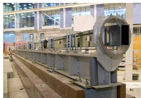
Neutronenleiter aus doppelt elliptisch gebogenen Superspiegeln
