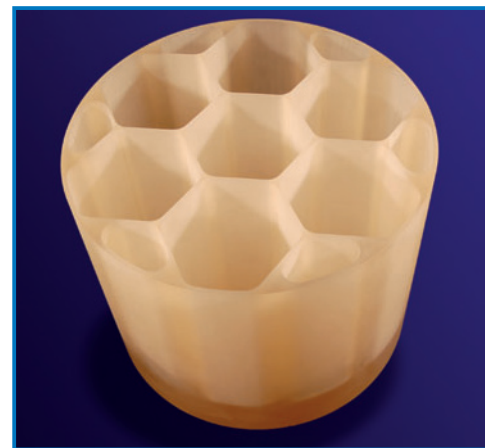
Steg-Dicken von 2 mm und Taschentiefen von 190 mm bei einem Ø 300 mm Muster erreicht durch Einsatz von Diamant-Schleifwerkzeug
