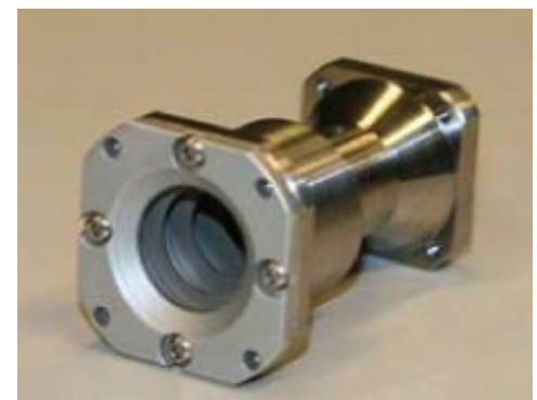
Das SwissCube Teleskop, welches Bilder von dem „Airglow“ aufnehmen wird
