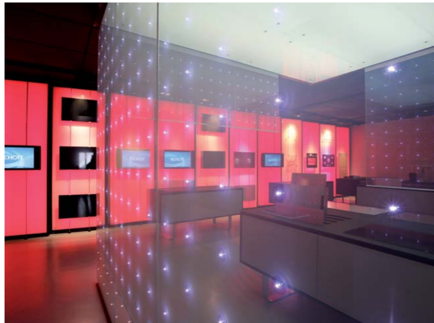
Links: Kombination zwischen LEDs (LightPoints) und Polymermatrix (SmartView) Rechts: OPALIKA® mit einer RGB-gesteuerten Hinterleuchtung
