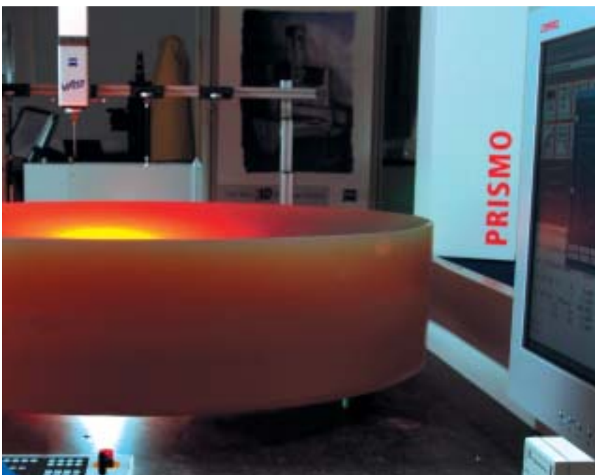
Moderne Koordinatenmesstechnik in der Endprüfung von ZERODUR®
