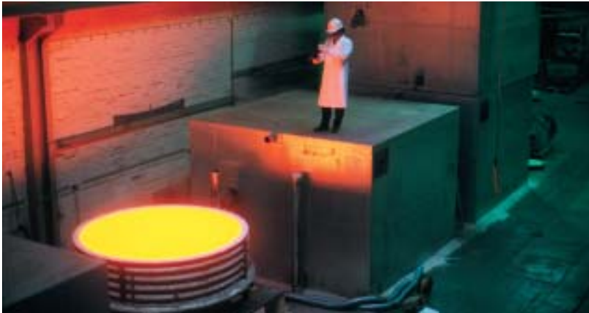
Ein Spiegelträgerguss von 2 m Ø wird in den Abkühlöfen eingebaut.
