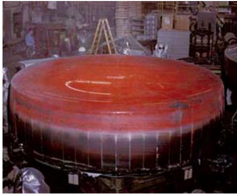
Einer der ersten 4 m ZERODUR® Güsse aus den frühen 70er Jahren. Die Anlagen und Prozesse wurden seitdem signifikant weiterentwickelt, um den steigenden Anforderungen des Marktes zu genügen.
