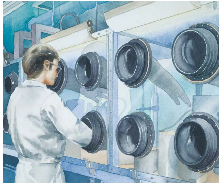
In der Glove-Box werden Arbeiten an strahlenden Materialien verrichtet. Schutz bietet hier Strahlenschutzglas RD 50.
